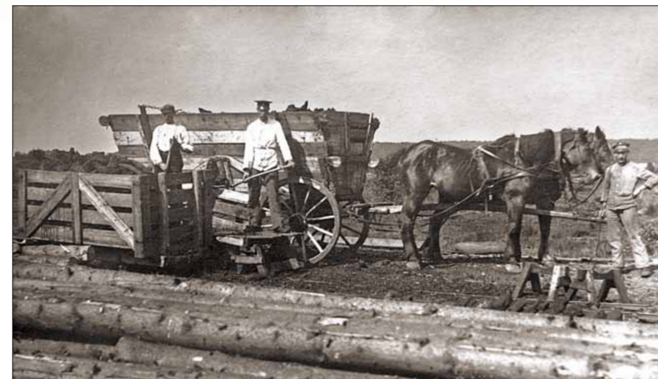
Der Torf wurde zunächst von den Loren auf Pferdefuhrwerke zum Weitertransport nach dem Bahnhof Quickborn verladen
